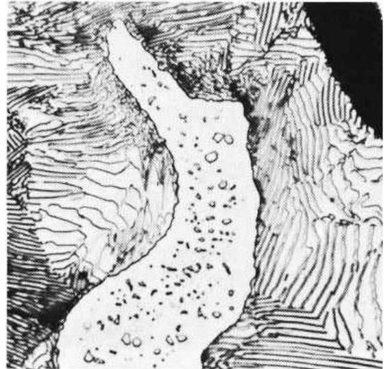
Fig.V.10h: Fundición gris clase 30B con área de steadita y grafito tipo A en matriz de perlita, atacado con Nital, 1500x.
