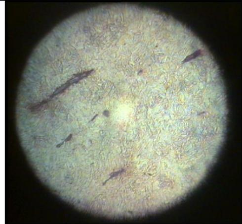
Fig.V.10b: SAE 4140 templado, se observa martensita e inclusiones alargadas de sulfuro de manganeso, 500x.
