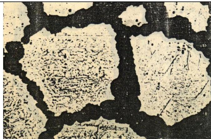
Fig. V.8: Estructura resultante de un temple incorrecto: troostita en bordes de grano (oscuro) el resto es martensita.
