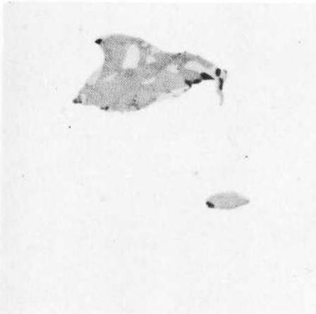
Fig.V.10a: Sulfuros mixtos de Fe y Mn conteniendo unos pequeños puntos de óxido (negro). Tal cual pulido, 1000x
