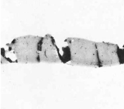
Fig.V.10c: Inclusión longitudinal de sulfuro segmentado en acero de tubos SAE 1215 estirado en frío, Tal cual pulido, 1000x.
