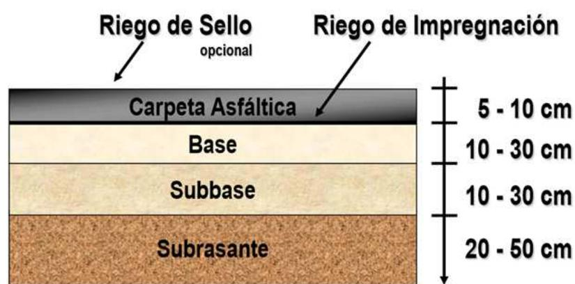
La *capa de rodadura* de un pavimento flexible puede contruirse con un hormigón bituminoso, mezclas de arena y betún, o mediante tratamientos superficiales con riegos bituminosos.
