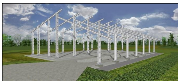
Figura 4. Montaje de vigas de pórticos
