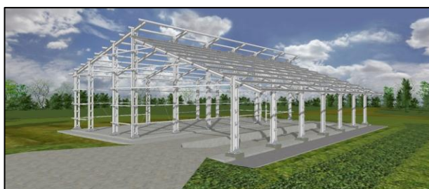
Figura 7. Montaje de correas.
