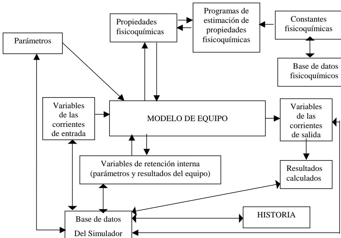
**Figura 6: Arquitectura típica de un simulador modular secuencial**
