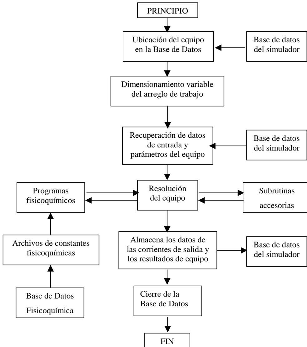
**Figura 7: Esquema de cálculo de cada módulo o equipo del simulador**
