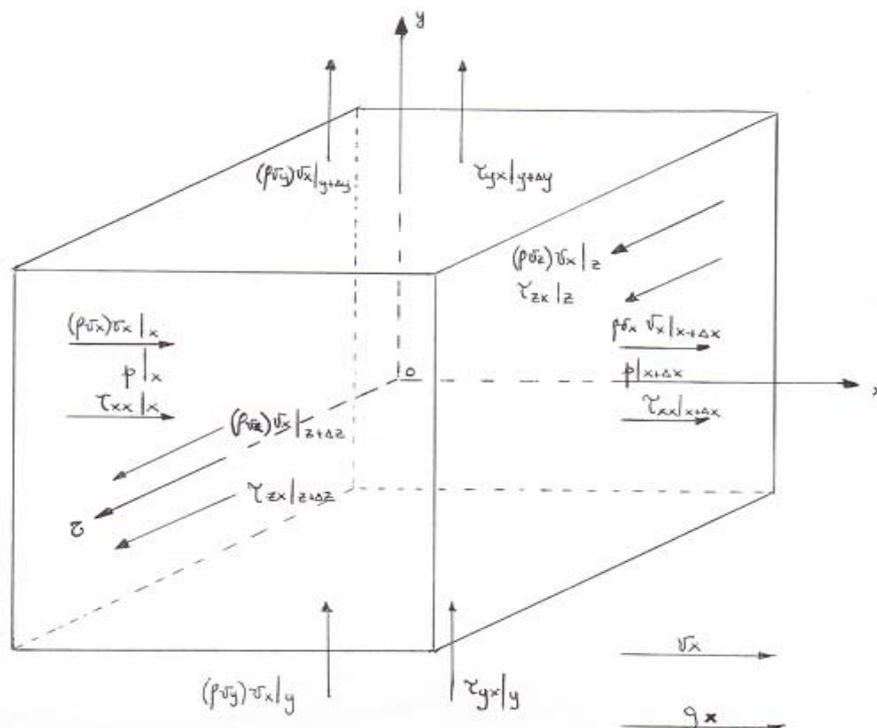
1- El termino de flujo global o velocidad de flujo de cantidad de movimiento por convección a través de las seis caras, puede representarse por el producto de la componente de la “velocidad másica” ( $\rho v$ ) con la velocidad en dirección  $x$  ( $v_x$ ) multiplicadas por el área transversal o superficie de la cara en cuestión. Por lo tanto, se puede escribir;
